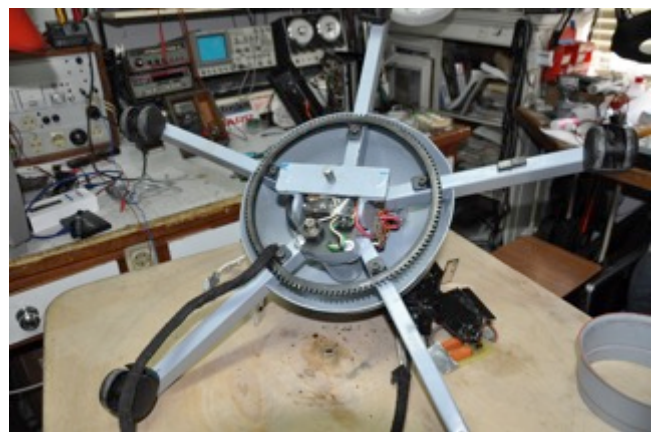
Figura 8: Estrutura mecânica de rotação e elevação, vista de baixo.
