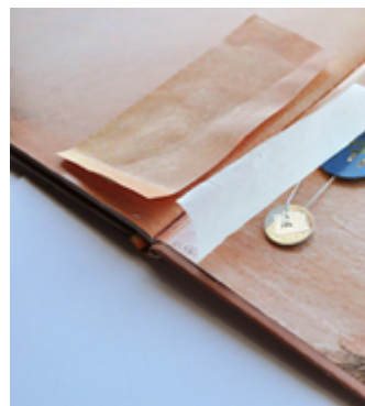
Figura 10: Módulo Bluetooth de pequenas dimensões e bateria.
