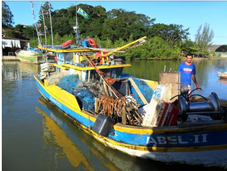
Figura 29: Detalhe dos artefatos (âncoras, ancorotes ou corotes) para fixação da rede de emalhe de fundo.
