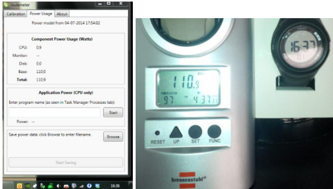
Figura 76 – Apuramento simulado e real do consumo energético de um SUT, em Watt. (Fonte Própria)
