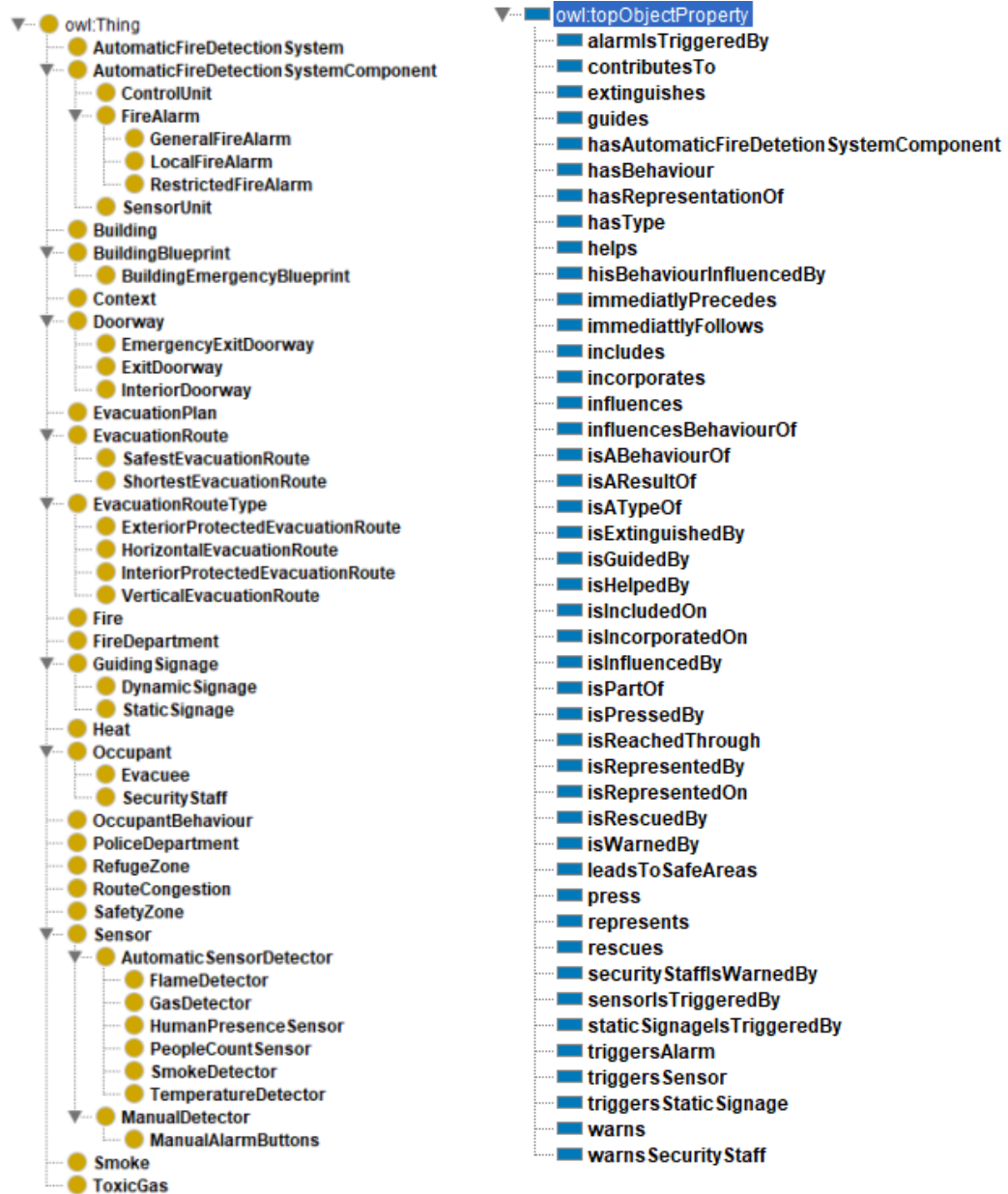
Figura IV.2 Lista de classes, subclasses e propriedades da ontologia para a evacuação de edifícios em caso de incêndio (Neto et al., 2022a). Obtida do Protégé,
