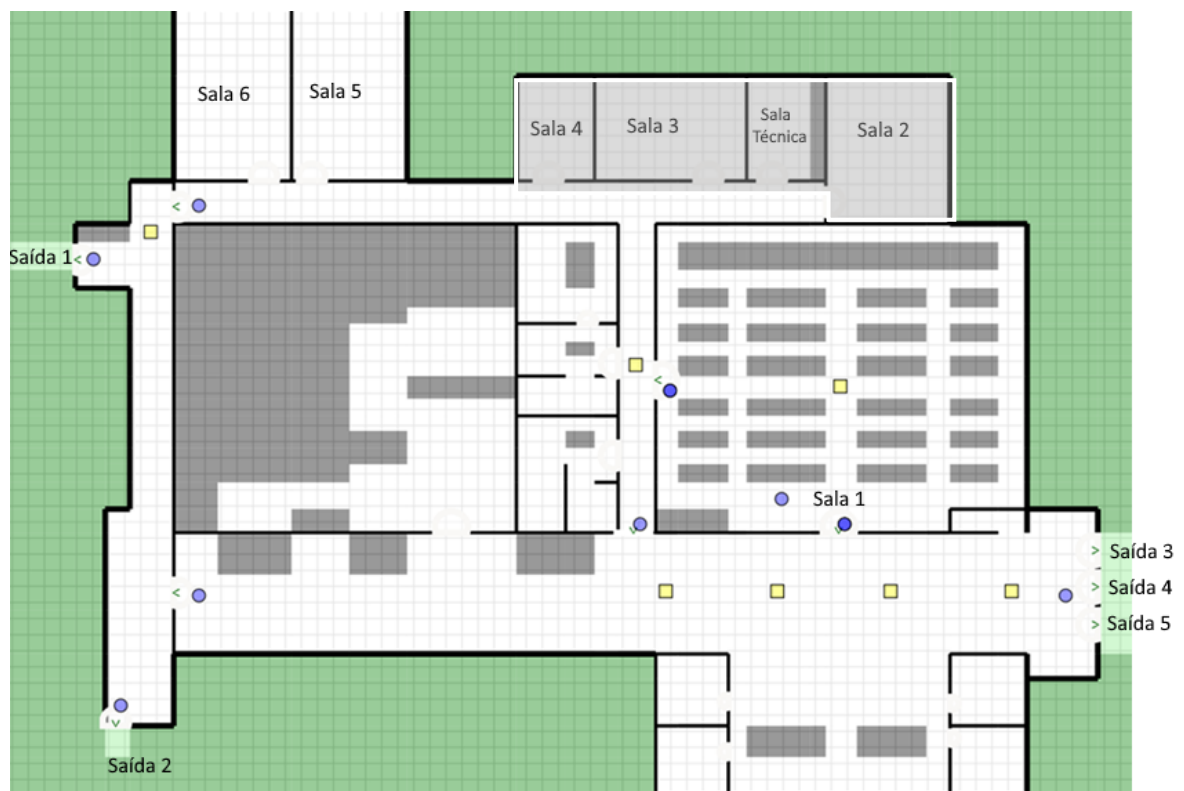
Figura V.8 Planta do Centro de Congressos com indicação a sombreado cinzento das salas onde se posicionaram os 30 ocupantes
