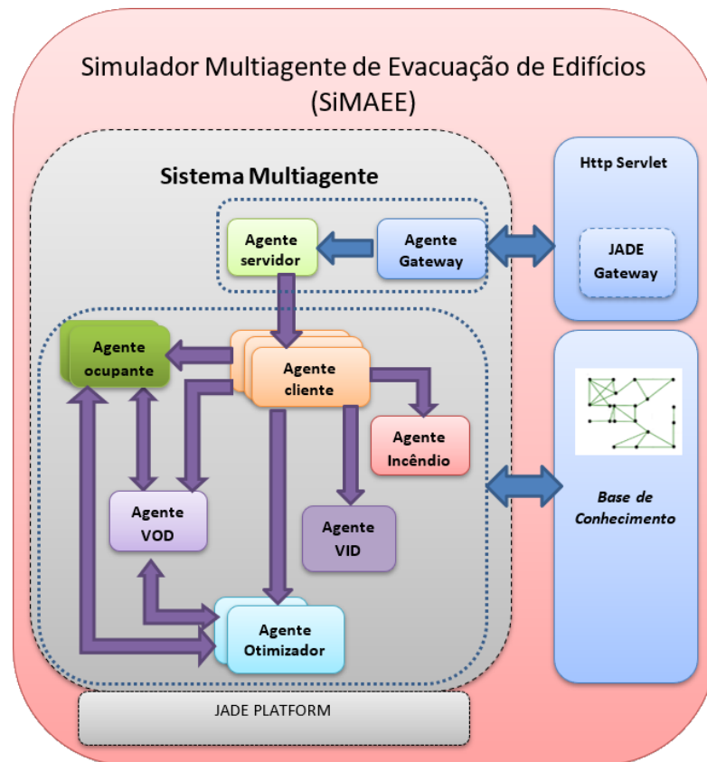
Figura III.17 Arquitetura do SiMAEE – Simulador Multiagente de Evacuação de Edifícios
