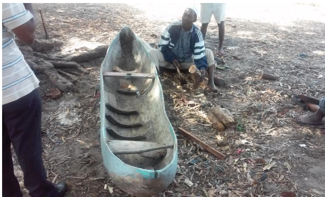
Fotografia 4: Reparação de uma canoa tipo tronco escavado
