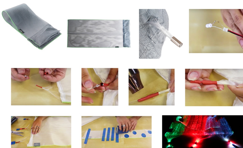
Fig. 204 - Processo de iluminação 257 de um têxtil de fibra ótica 258 .
