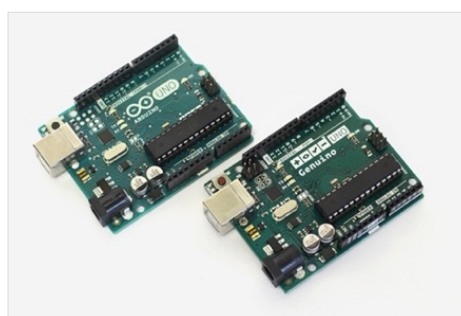
Fig. 170 - Microprocessador Arduino UNO (EUA) e Genuino UNO (restantes países) 219 .
