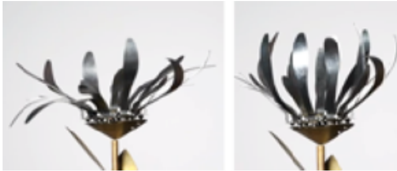
Fig. 139 - Elemento metálico construído em Nitinol 184 .
