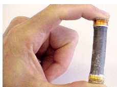
Fig. 157 - Polímero eletroativo artificial, já transformado em aplicação robótica 205 .
