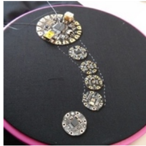
Fig. 187 - Vários sensores Adafruit, ligados ao mesmo pin do microprocessador 235 .
