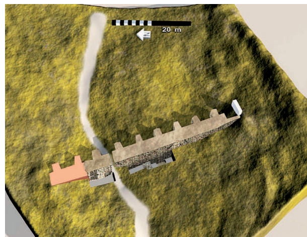
Reconstituição 3D da barragem, vista de montante, com indicação das sondagens arqueológicas
