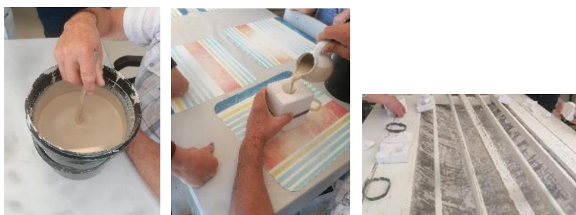
Fig.18/19/20: Experiências com barro em estado líquido. Da esquerda para a direita: Preparação do barro em estado líquido; transferência do barro para um molde de gesso; Remoção do excesso de barro líquido dos moldes de gesso.
