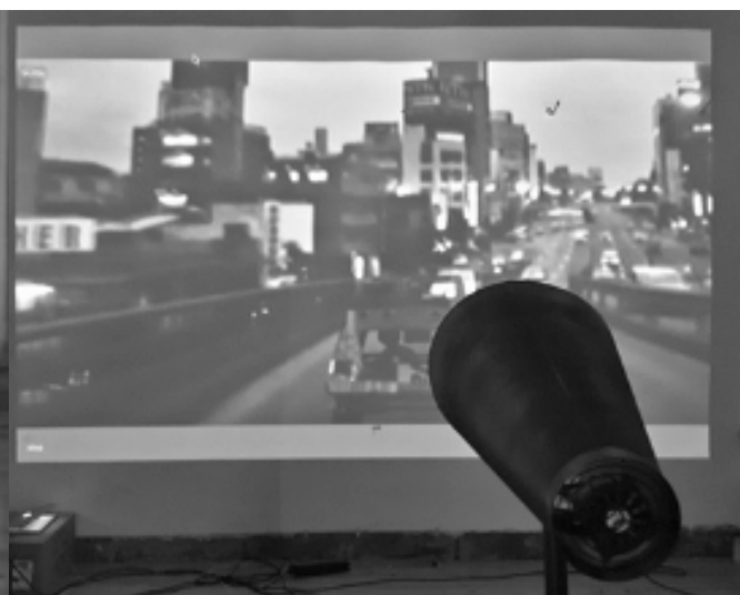
Figura 4.10: protótipo da estrutura interativa: projetor, computador, microprocessador arduino (processing) , ventoinha de arrefecimento, tronco de cone.
