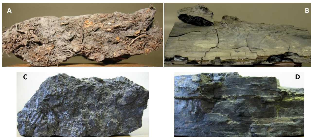
Figura 8 – Fotografias de turfa e dos diferentes tipos de carvão: A – Turfa; B – Lignite; C – Carvão betuminoso; D – Antracite.
