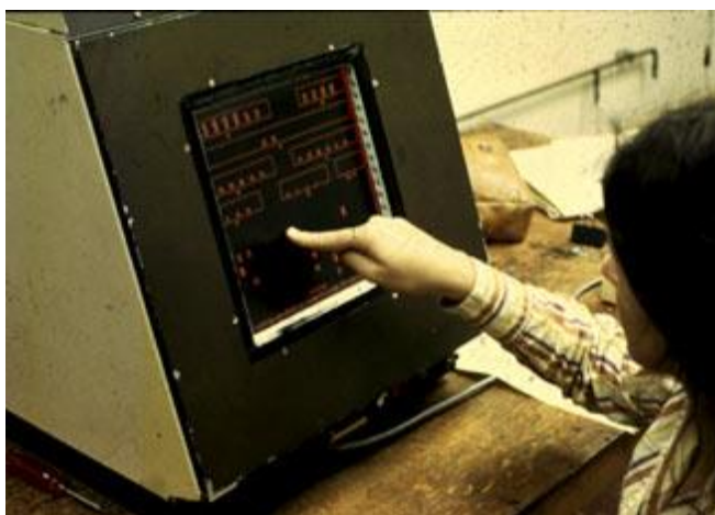
Figura 56 – Estação de trabalho PLATO IV com ecrã de plasma sensível ao toque
