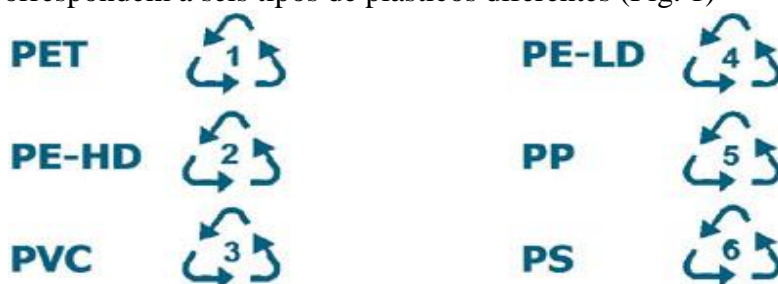
Figura 1- Códigos de reciclagem para plásticos de embalagens mais comuns. O número 7 diz respeito a outros tipos de plásticos.
