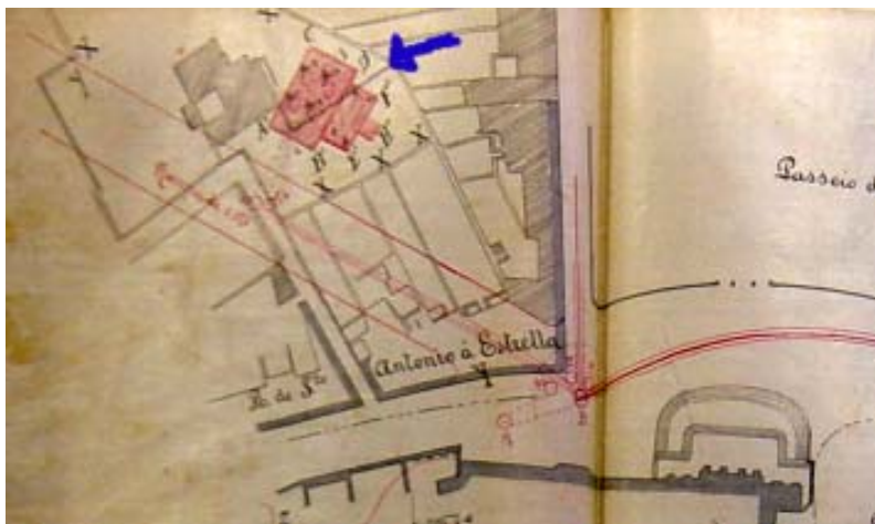
Figura 86 – Localização da casa das máquinas, assinalada pela seta azul. O edificio mais largo corresponde à casa dos motores, o seguinte corresponde à casa das caldeiras e, por último, a chaminé.
