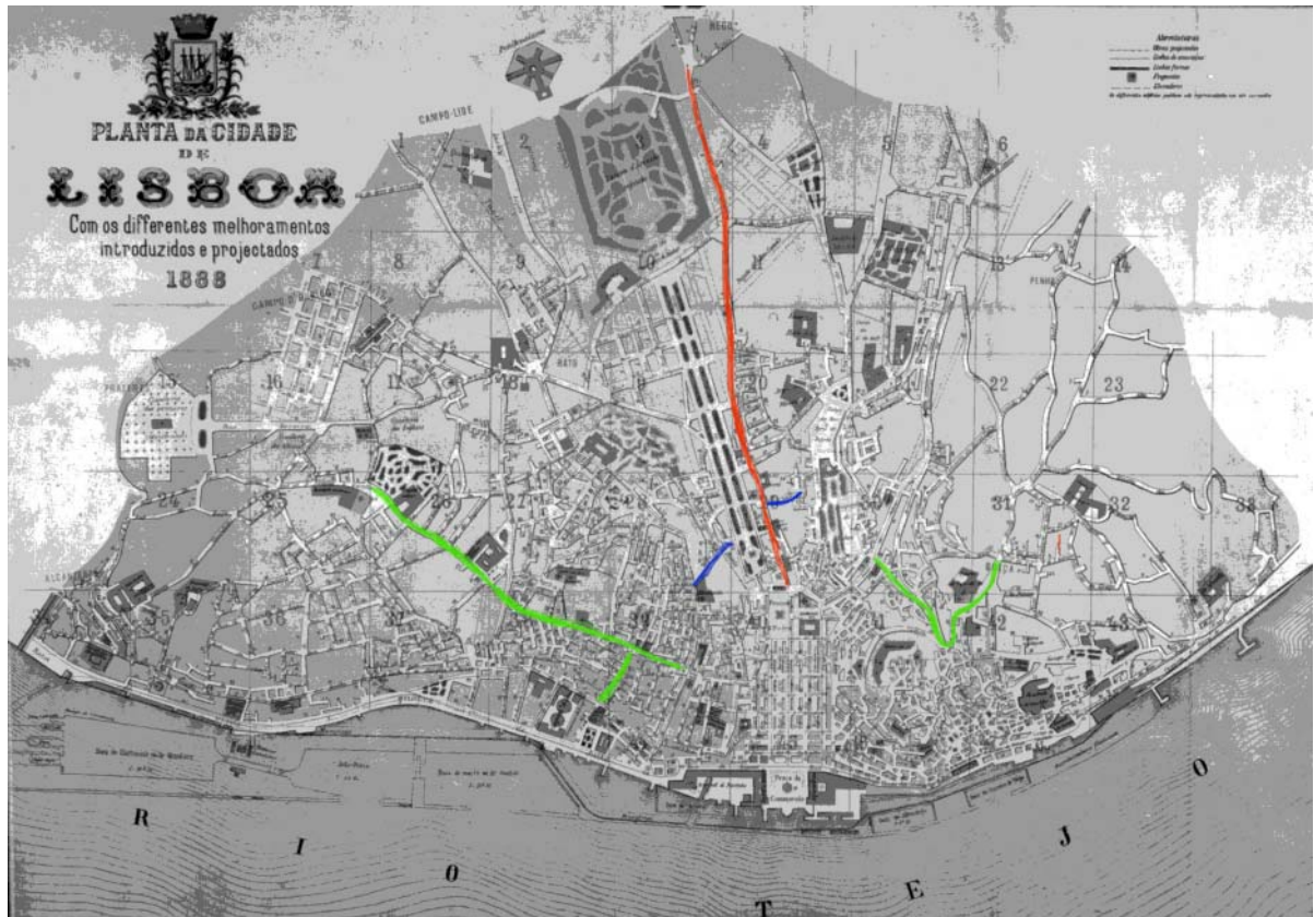
Figura 69 – Traçado das linhas de tramway-cabo efectivamente construídas na segunda fase: Estrela, Bica, S. Sebastião e Graça. Os dois funiculares de cremalheira, no Lavra e na Glória, estão assinalados a azul.
