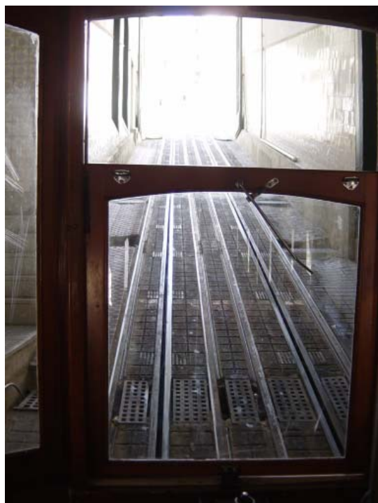
Figuras 95 e 96 – A linha da Bica com seis trilhos ao invés de quatro, como tinha no tempo do vapor.
