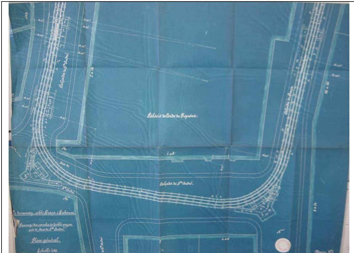
Planta técnica da passagem das curvas de Santo André e da Calçada da Graça.
