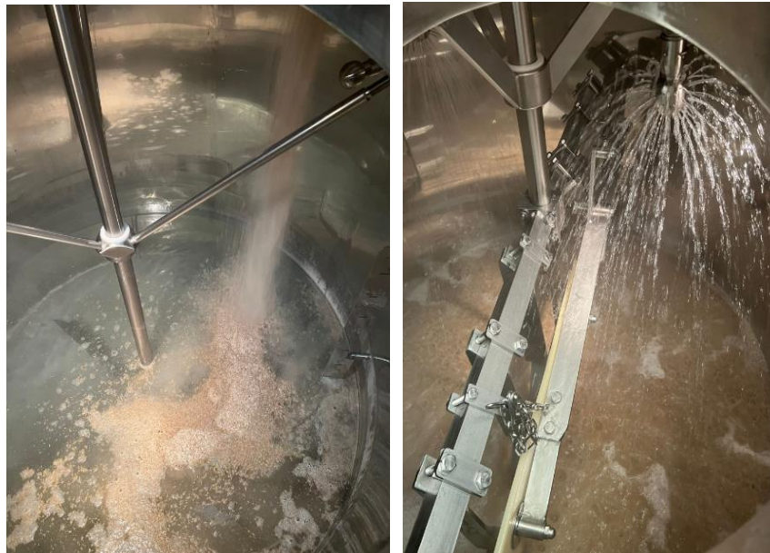
Figura 1.10: Início da empastagem (junção da água e do cereal).
