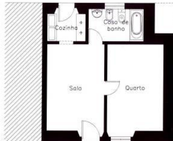
Figura 33 – Planta de piso da moradia tipo T1 (sem escala). Desenho do autor.
