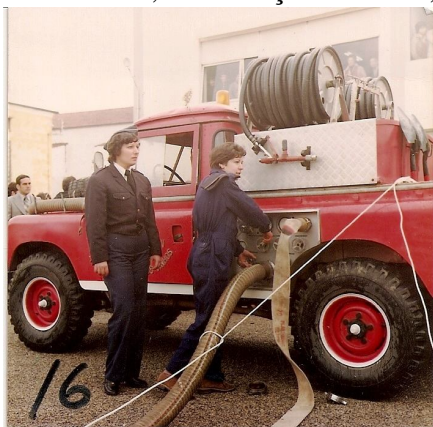
Fig.59 – Jeep «Land Rover» transformado em viatura de ataque a incêndios
