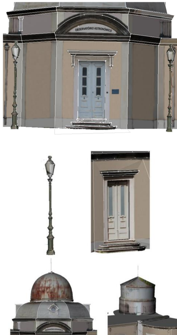
Figura 2 – Pormenores do modelo 3D fotogramétrico: fachada principal, candeeiro, porta com degraus e cúpulas.
