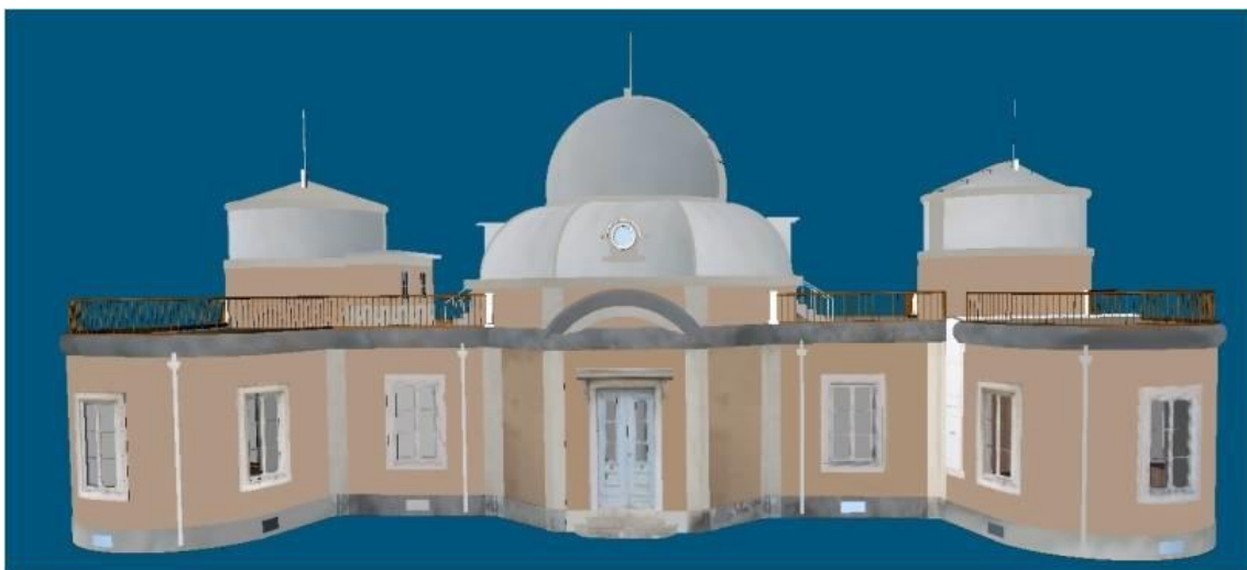
Figura 9 – Modelo 3D a partir de laser com textura fotográfica.
