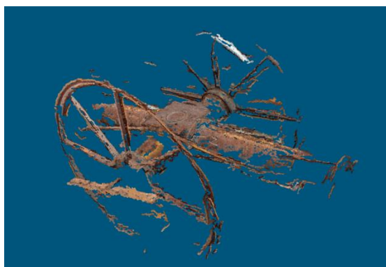
Figura 11 – (esq.) Círculo Meridiano Repsold. (dir.) Nuvem de pontos 3D obtida por VisualSFM.
