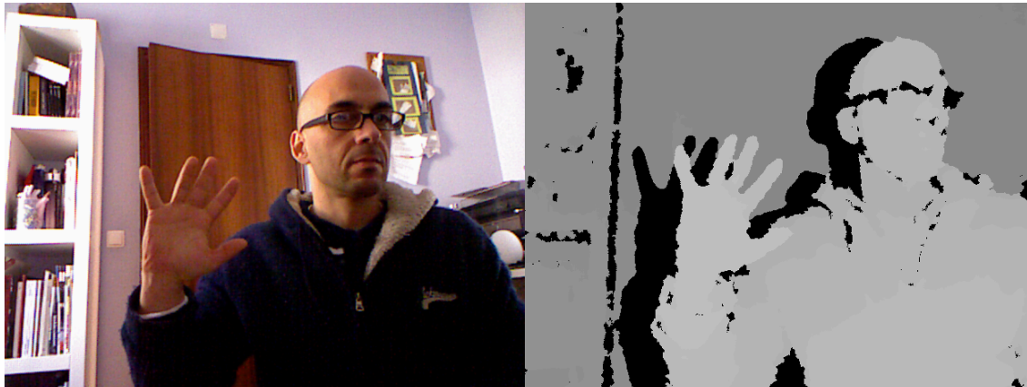
Figura 3.6 - Detecção com base na profundidade.
