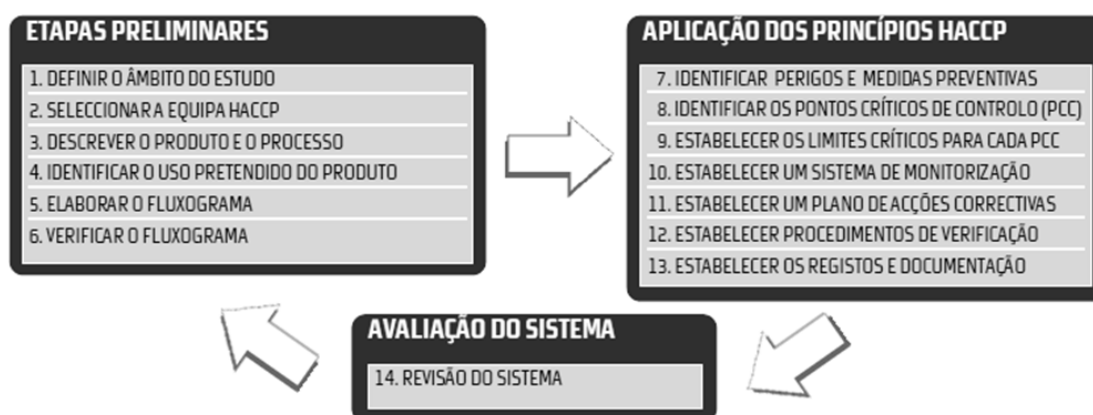
Figura 1: As catorze etapas (subdivididas em três fases) de implementação do HACCP (Afonso, 2006).
