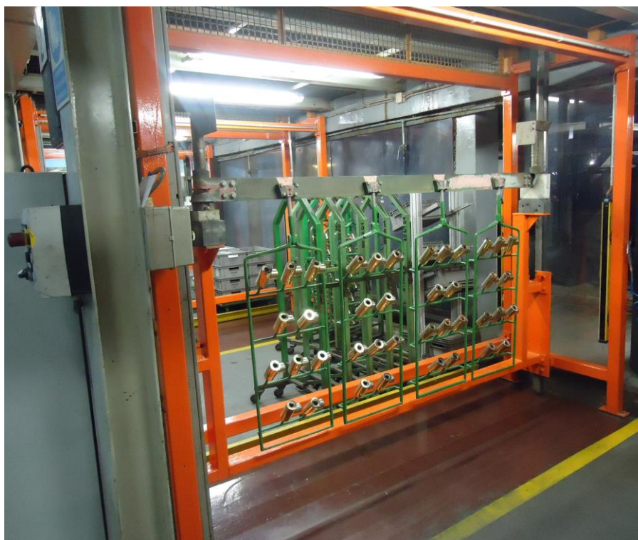
Figura 3.10 - Suspensões metálicas com corpos no processo de elevação
