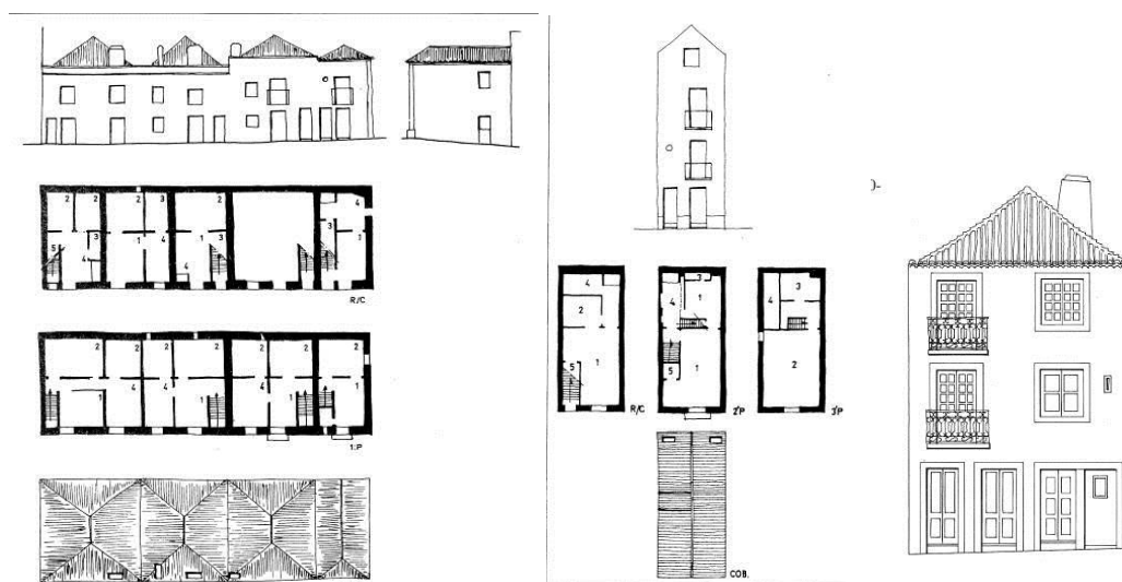
Fig. 30: Exemplos da arquitectura civil, dita «vernácua», que sobrevive nalguns locais do Bairro Alto e que representa a construção alinhada do séc. XVI e XVII e integrada no conceito de quarteirão da malha urbana que estruturou a implantação do Bairro desde o séc. XVI. In: A. Reis Cabrita e outros, Manual de Apoio à Reabilitação dos Edifícios do Bairro Alto , 1993, CML, LNEC, p. 45, 46 e 110.
