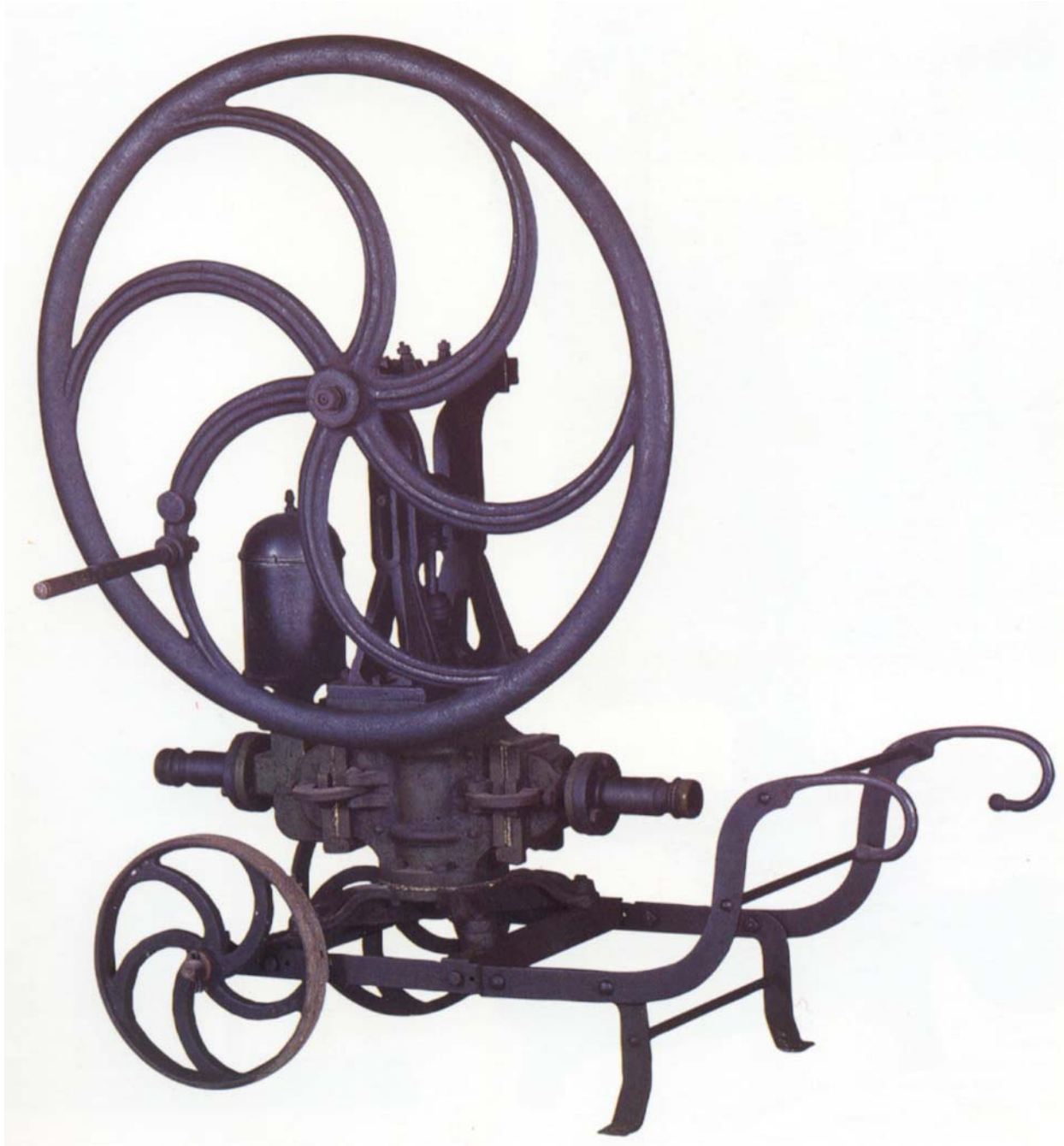
Fig. 16: Bomba de trasfega em ferro. S/marca; s/origem; s/data. Foto: Egídio Santos Museu Nacional do Vinho – Alcobaça (A Junta Nacional do Vinho possuía vários exemplares deste tipo de bomba)
