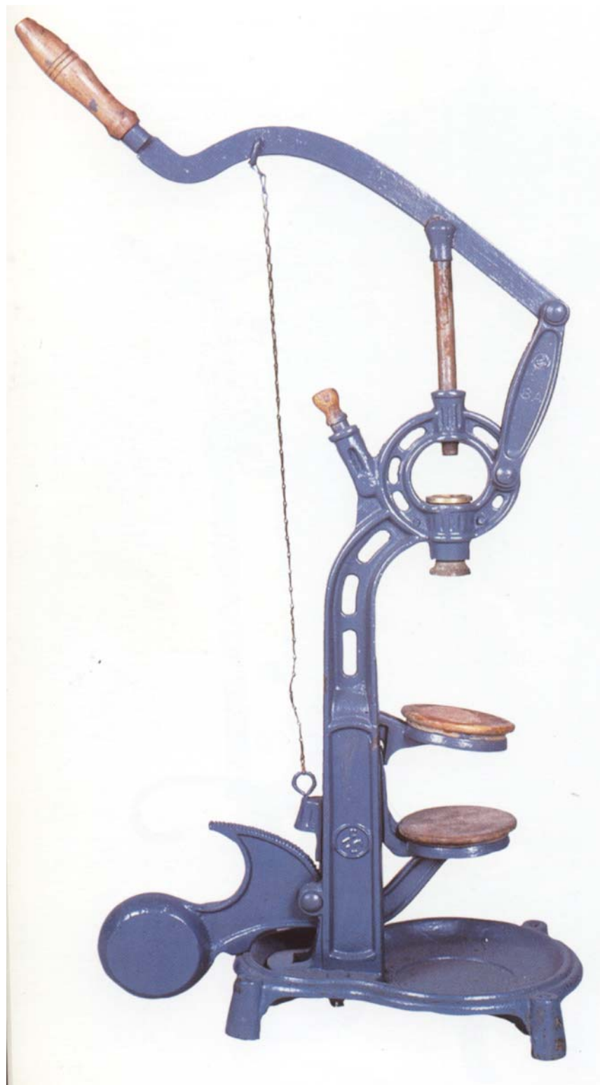
Fig. 10: Rolhador/Arrolhador em ferro e madeira. S/marca; s/origem; s/data. Foto: Egídio Santos Museu Nacional do Vinho – Alcobaça (A Junta Nacional do Vinho adquiriu vários exemplares deste tipo de utensílio)
