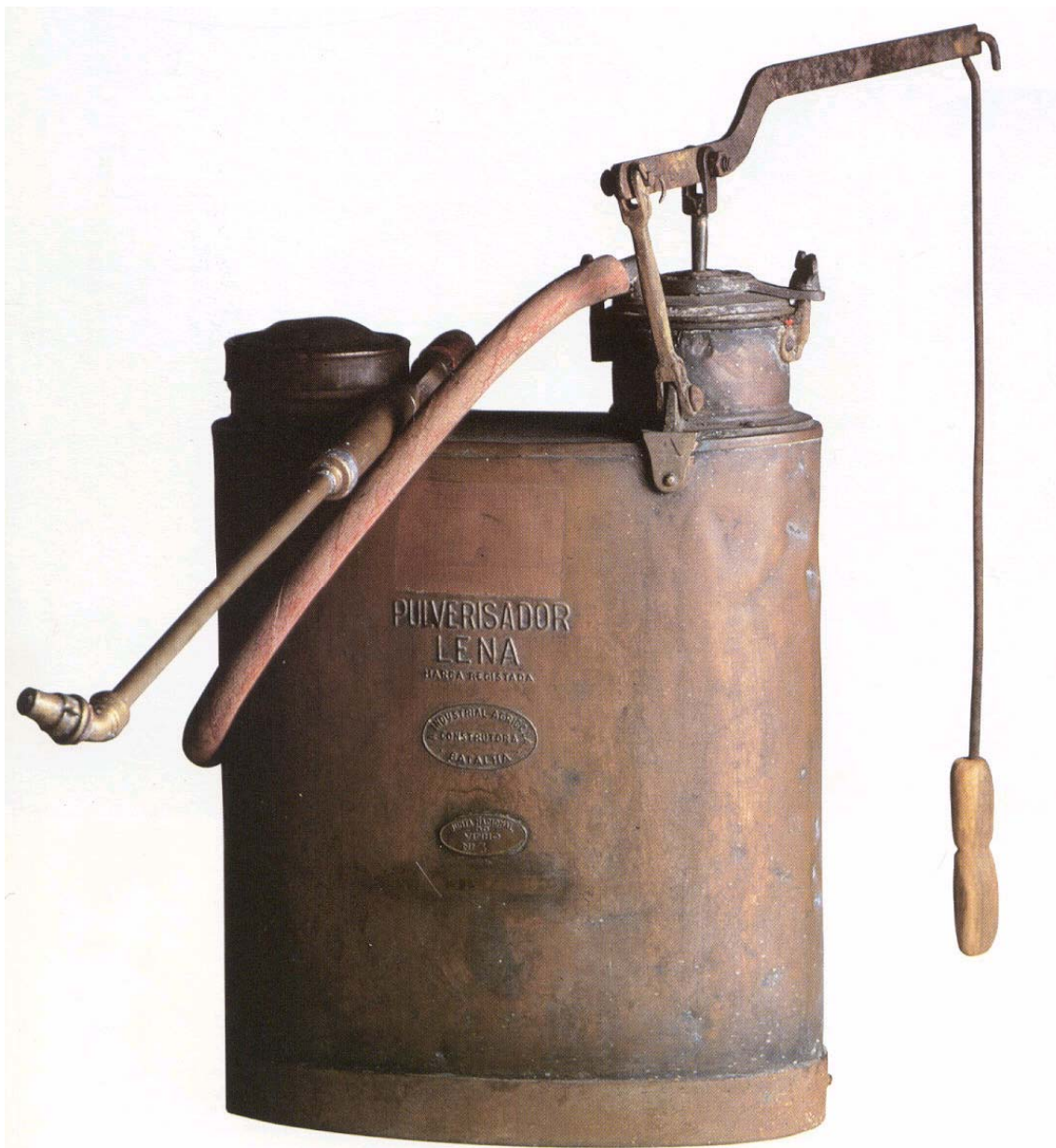
Fig. 11: Pulverizador (Sulfatador) em cobre, ferro e madeira. Marca Lena, de origem nacional (Batalha), s/data.
