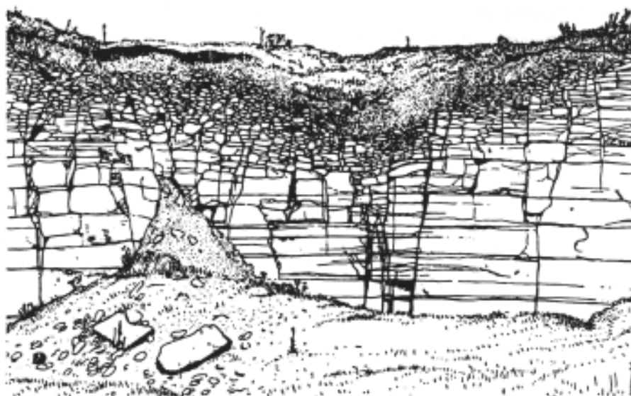
Figura 2.1 – Aspecto geral da meteorização: a rocha firme vai-se transformando gradualmente de baixo para cima em solo detrítico não consolidado.
