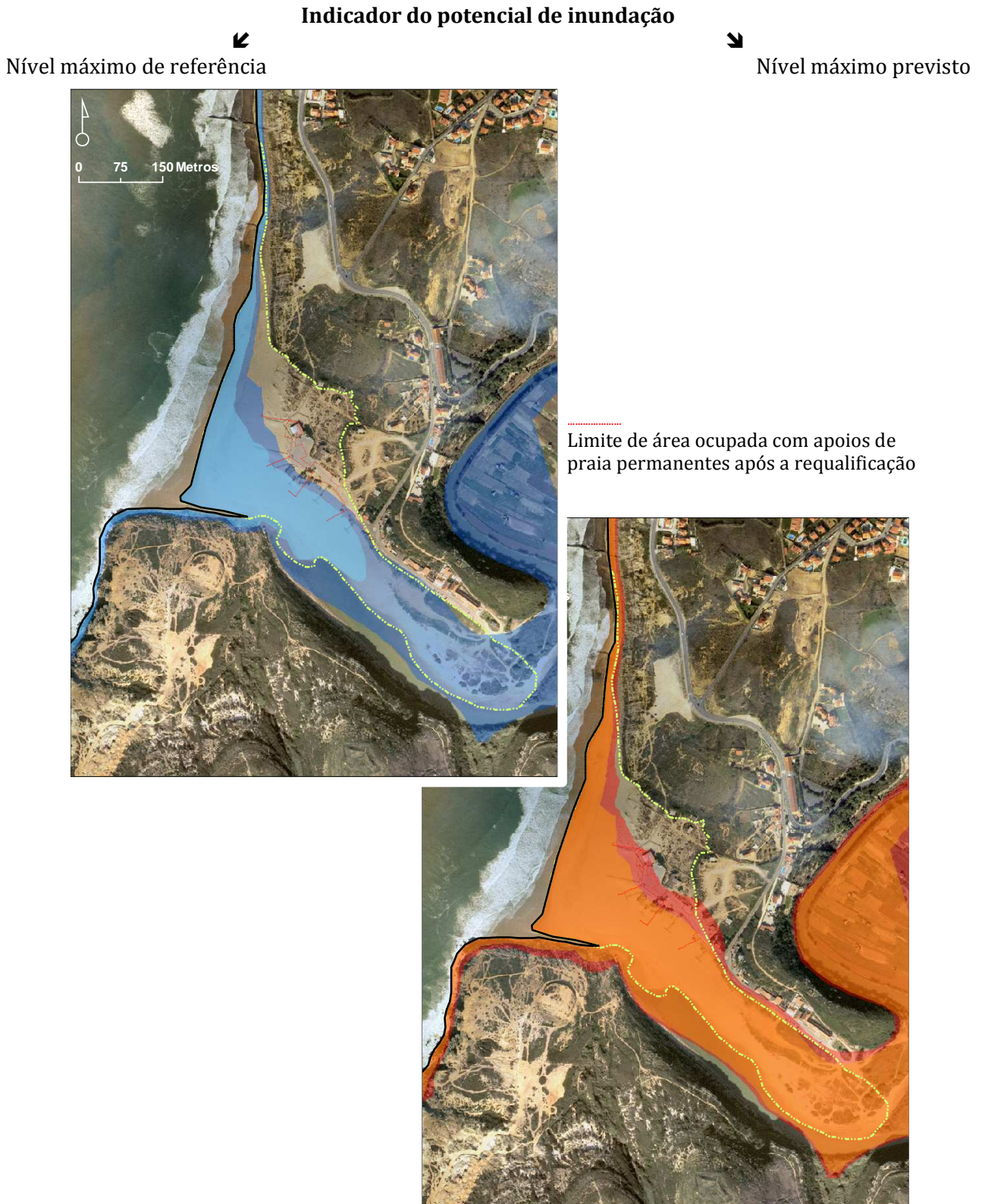
Figura 6.7 – Susceptibilidade de inundação na praia da Foz do Lizandro. Legenda na Fig. 6.5.
