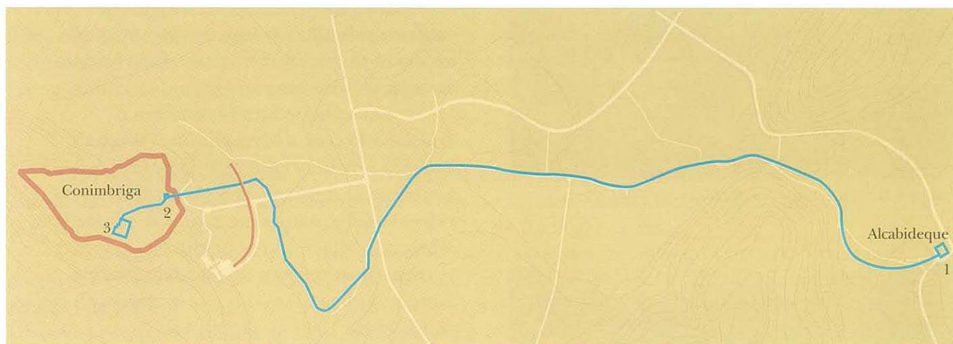
Traçado do aqueduto de Conimbriga desde a nascente de Alcabideque (1) às termas ao sul do Fórum (3), passando pela torre de distribuição (2).
