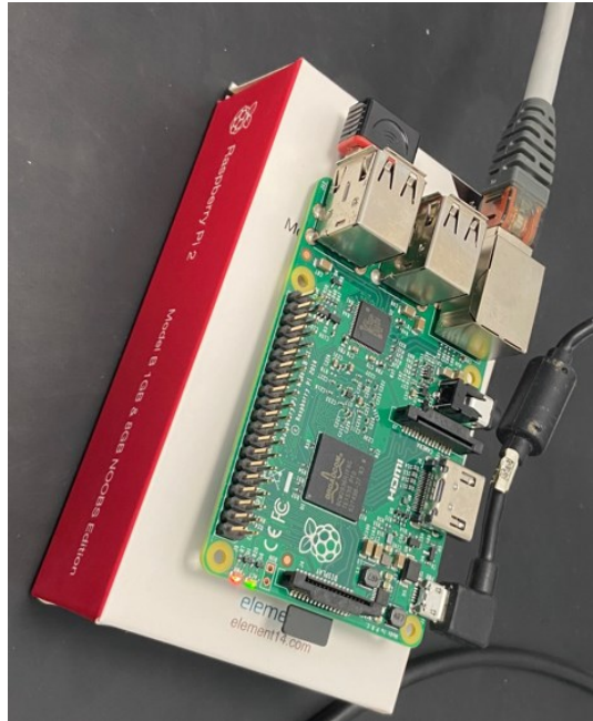
Figura 19 - Raspberry Pi para acesso ao servidor usado conectar com a PECU
