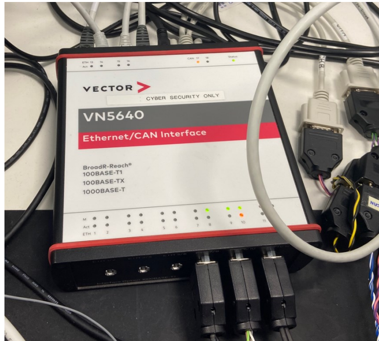
Figura 21 - Vector VN5640: Switch que permite a comunicação entre os dispositivos
