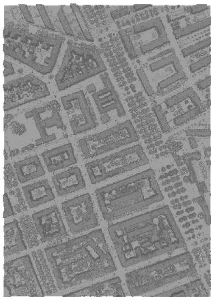
Figura 10: Resultado para o MDS obtido de dados LIDAR (sem restituição fotogramétrica).
