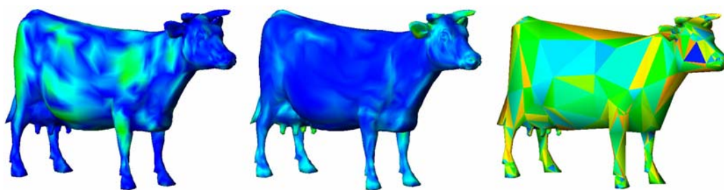
Figura 4 – Modelos coloridos de acordo com os resultados obtidos com diversos números de mérito: da esquerda para a direita, desvio geométrico, curvatura Gaussiana e qualidade dos triângulos.
