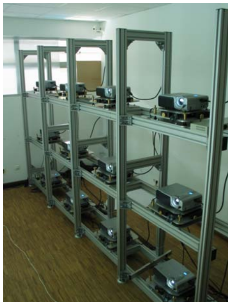
Figura 3: Estrutura de suporte dos projectores
