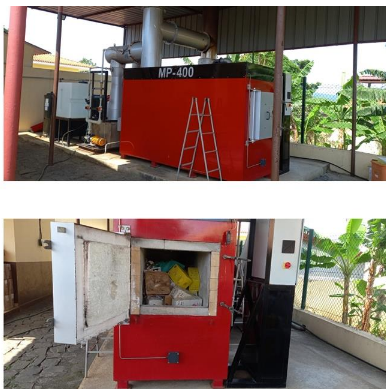
Figura 5.12: Incineradora no CGRSS, Ilha de São Tomé. Superior: vista lateral; em baixo: vista frontal.
