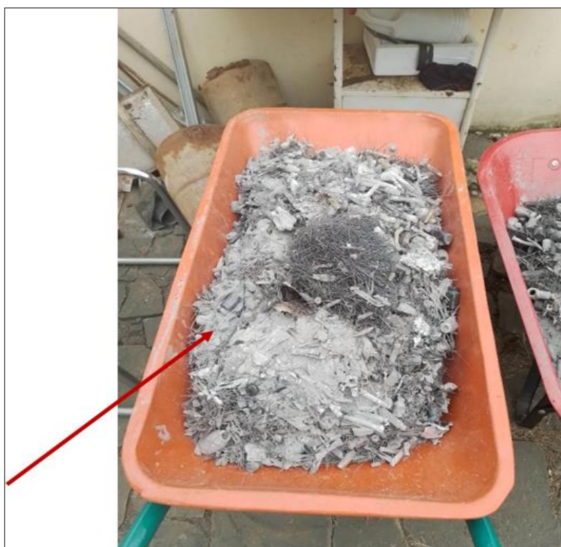
Figura 5.13: Produto final da incineração. A seta mostra as escórias.
