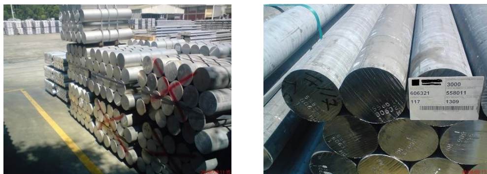
Figura III. Pátio de cargas e Identificação por código de barras no pátio. Fonte: Tachion Tecnologia & Sistemas (2008) Fonte: Tachion Tecnologia & Sistemas (2008)
