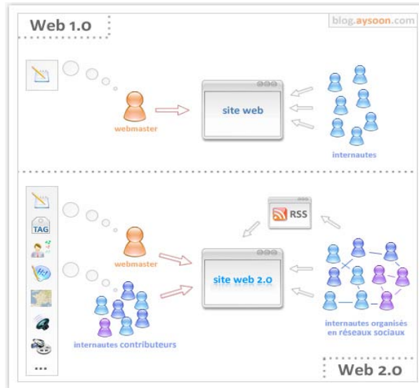
Figura 3.2: Comparação entre a Web 1.0 e a Web 2.0: de consumidores para potenciais colaboradores, organizados em redes sociais.
