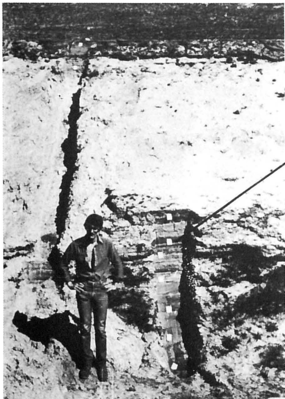
Foto 6a) — Corte estratigráfico realizado nos depósitos da foto anterior. Predominam os materiais arenosos finos; as diferenças de coloração são devidas à presença de matéria orgânica.
