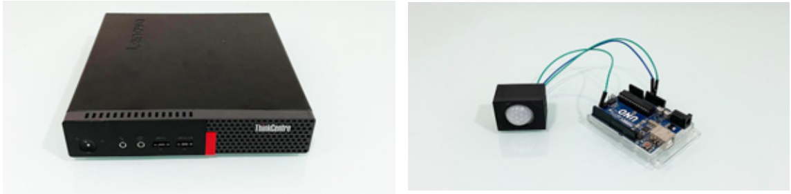
Figura 5.48 - Equipamento utilizado na instalação "AFSTAR e APROXIMAR": um computador e um sensor de movimento infravermelho (PIR) integrado a um arduino.
